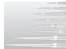
● ISMART吸嘴按照严格的制造规范在全自动，无人触感的生产设备中生产。这些吸嘴是由高品质金刚石完成模具生产使用FDA批准的特殊医疗级纯聚丙烯，高透明度不含DNase,RNase,人类DNA, Pyrogen和PCR抑制剂。理想的匹配高敏感性PCR工作，不含润滑剂和重金属，创新的设计的适应性与各种移液器适用性最小的力量要求的装载和弹出，吸嘴的轮廓和尺寸已经精确地设计，以确保分配的液体对于每个生产的吸嘴是可预测的和精确的，所有提示上都有刻度标记，作为视觉检查，以尽量减少样品吸入过程中出现错误的风险包装中的独特标签编码，便于识别。
